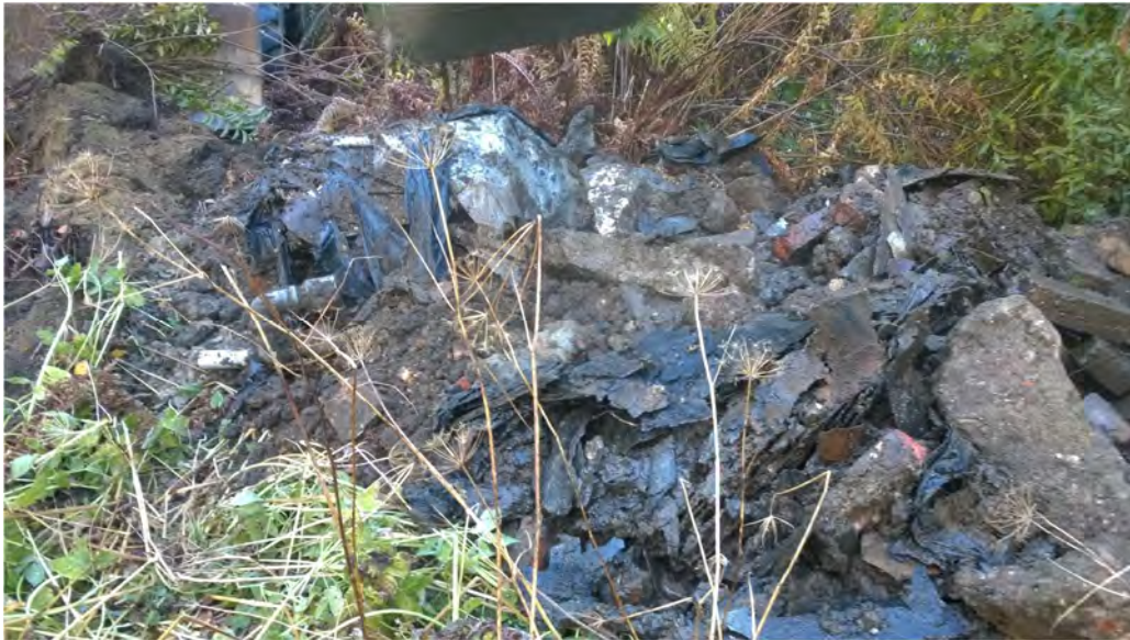
Kuva 1. Koekuopan KK5 kaivumassoja; rakennusjätettä mm. betonia, tiiliä, puuta, muovia, lasia yms.
