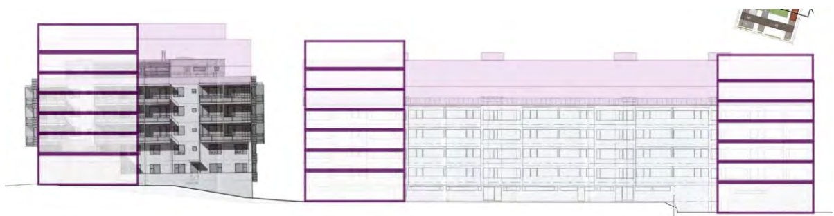
Kuva 17. Luonnosvaiheen vaihtoehto 1. Korttelleikkaus. Täydennysrakentaminen on osoitettu violetilla. Ramboll Finland Oy 19.11.2020.
