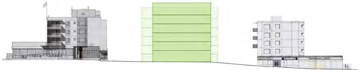
Kuva 28. Luonnosvaiheen vaihtoehto 2. Korttelijulkisivu Maunukselankadulle. Täydennysrakentaminen on osoitettu vihreällä. Ramboll Finland Oy 19.11.2020.
