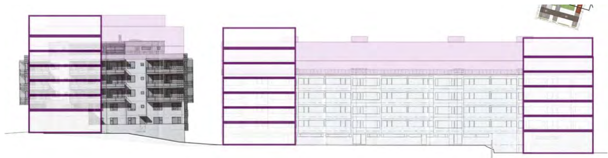
Kuva 17. Luonnosvaiheen vaihtoehto 1. Korttelileikkaus. Täydennysrakentaminen on osoitettu violetilla. Ramboll Finland Oy 19.11.2020.
