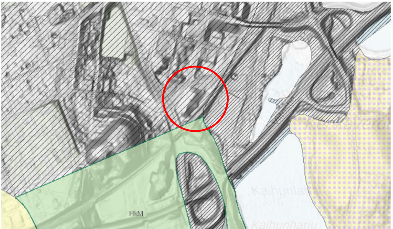
Kuva 6. Karttaote GTK:n Maankamara-palvelusta. Harvaan raidoitettu alue on kartoittamatonta, tiheään raidoitettu alue on täyttemaata ja vihreän alueen maaperä on hiekkaa. Suunnittelualan likimääräinen sijainti on osoitettu punaisella ympyrällä.
