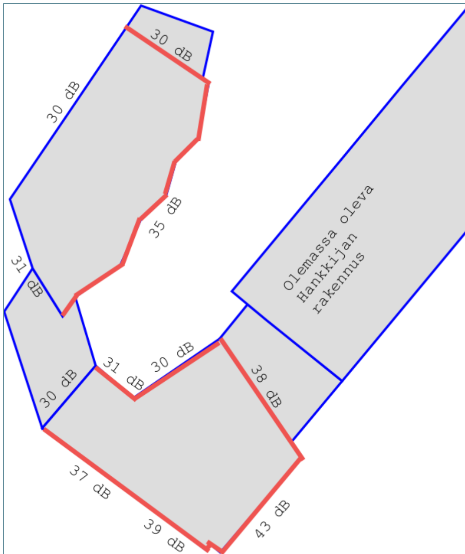
Kuva 9 Äänitasoeron lasketut suositukset ilman varmuusmarginaalia.
