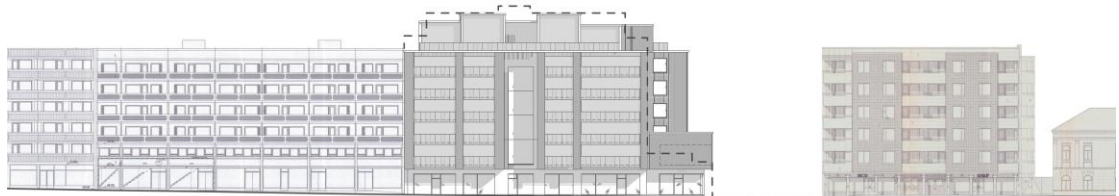
Kuva 17 Uuden kaavan mahdollistama esimerkinomainen rakennusmassa sovitettuna Porrassalmenka- dun katujulkisivuun. Uuden rakennuksen räystäslinja sopeutuu 6-kerroksisiin naapurirakennuksiin, sillä ylin kerros on sisäänvedetty. Alimmassa kerroksessa naapurirakennuksen arkadikäytävä jatkuu ja
