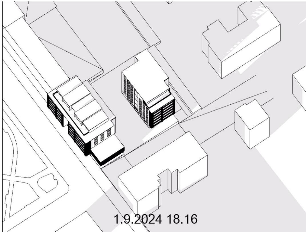
Kuva 16 Ote varjostustarkastelusta, tilanne 1. syyskuuta. Suunnittelualueen kaakkoispuolella osoitteessa Savilahdenkatu 1 on 7-kerroksinen asuinkerrostalo, jonka ikkunänäkymiä viitese suunnitelman mukainen B-talo muuttaa. Uusi rakennus sijoittuisi noin 30 metrin etäisyydelle nykyisestä rakennuksesta. Uusi rakennus sijoittuu olevan rakennuksen länsipuolelle, eli uusi rakennus varjostaa iltaisin matalalta paistavan auringon aikaan Savilahdenkatu 1:n julkisivua.
