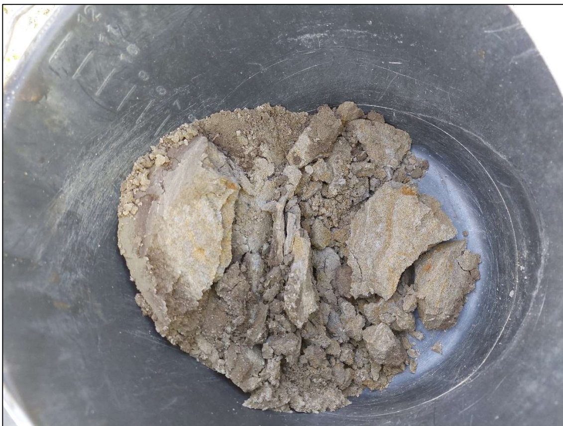
Kuva 7. Täyttökerrosten alapuolinen luonnollinen maaperä oli tutkimus-alueella siltistä hiekkaa. Kuvassa maaperänäytettä tutkimuspisteestä SE6 2,0-3,0 m syvyydeltä maanpinnasta.
