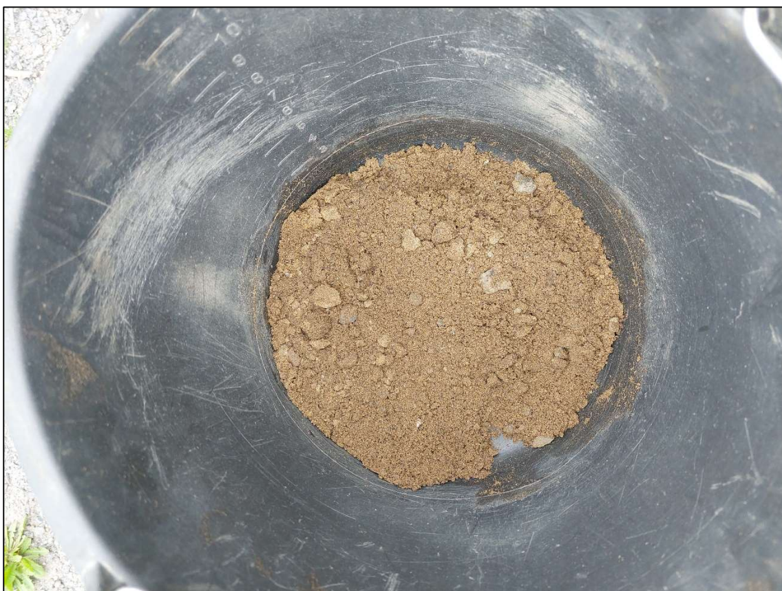
Kuva 4. Täyttökerrokset olivat tutkimusalueella pääosin hiekkaa. Kuvassa maaperänäytettä tutkimuspisteestä SE3 1,0-2,0 m syvyydeltä maanpinnasta.
