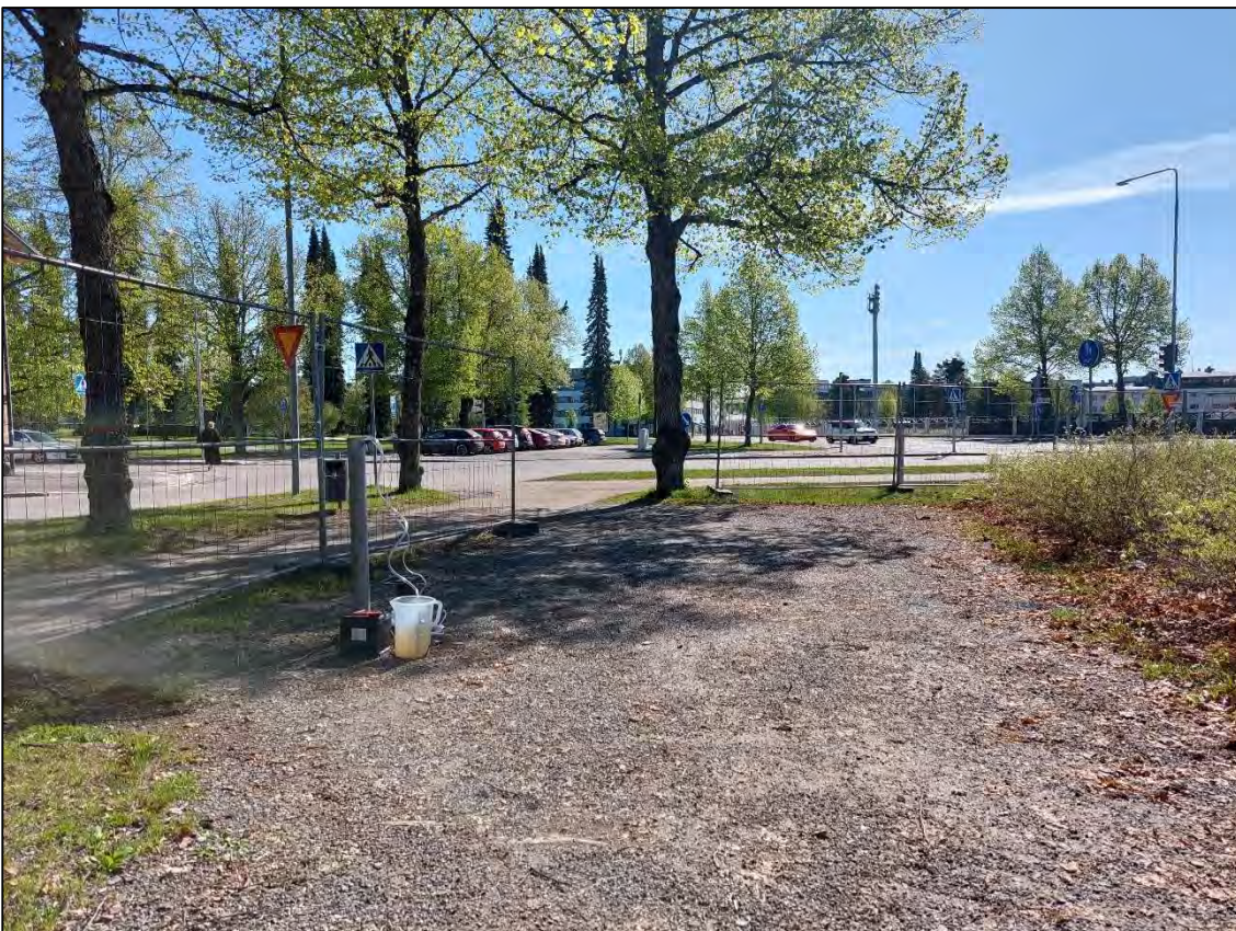
Kuva 10. Tutkimusten yhteydessä otettiin pohjavesinäyte kiinteistön pohjoisosassa olevasta pohjaveden havaintoputkesta 83.
