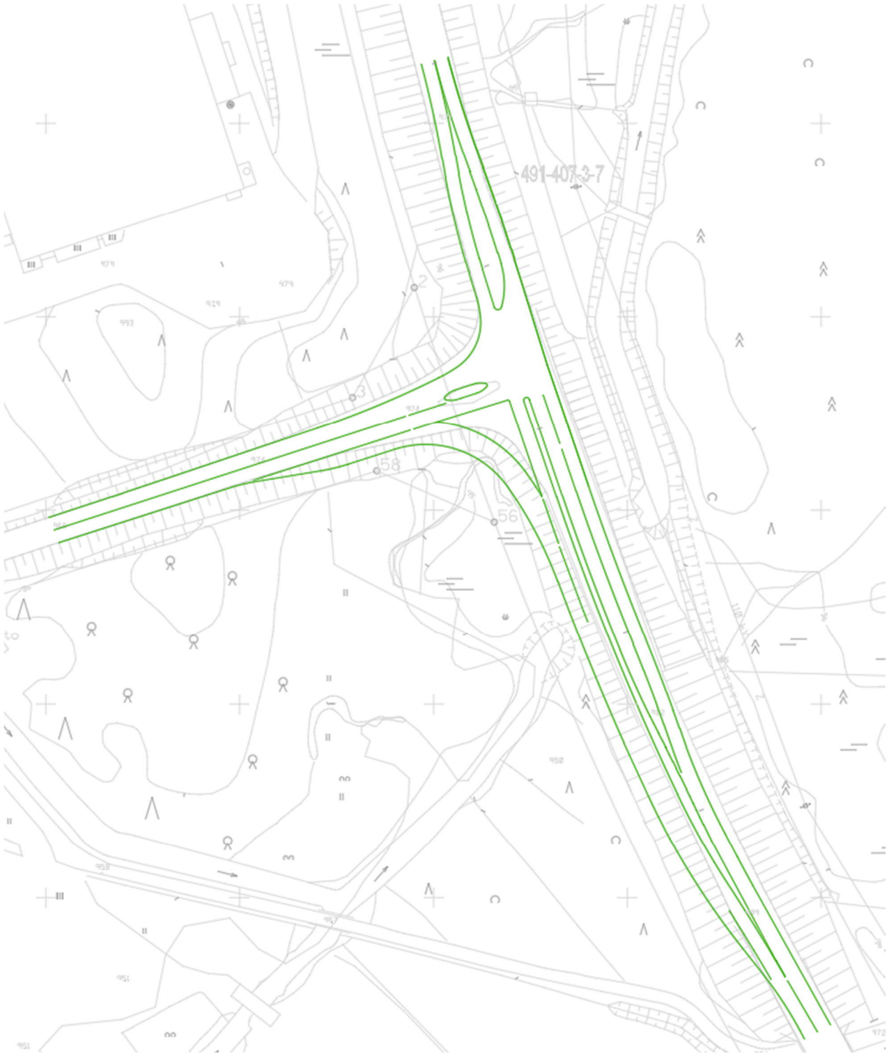
Kuva 23: Vapaa oikea -kehitysvaihtoehto, jossa toteutettaisiin kääntymiskaista etelä- ja länsisuunnille, sekä eteläsuunnan liittymiskaista.
