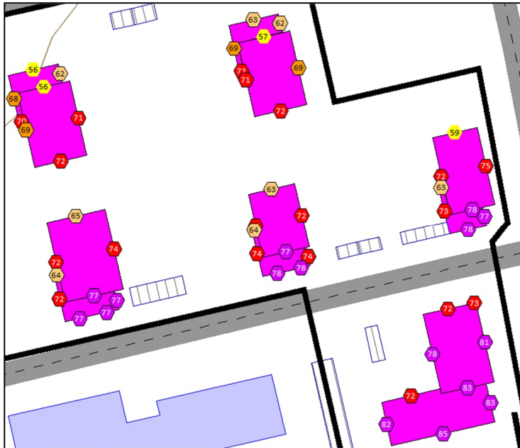
Kuva 19 Vaiheen 2. raideliikenteen aiheuttamat enimmäisäänitasot LAFmax julkisivuilla.
