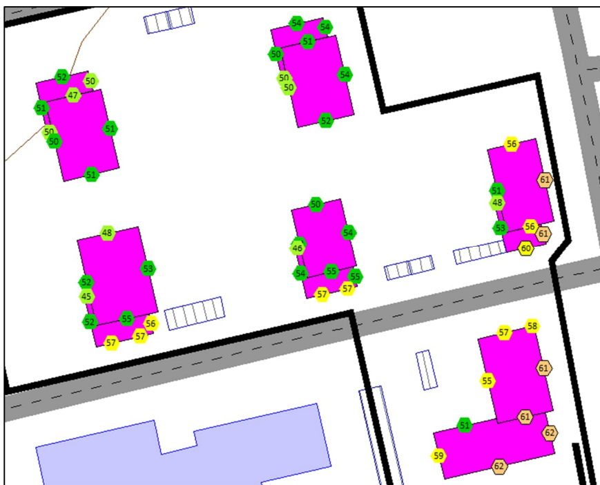
Kuva 16 Vaiheen 2. päiväajan keskiäänitasot julkisivuilla.
