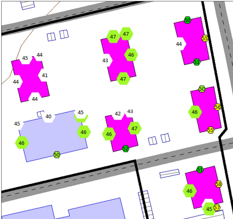
Kuva 7 Julkisivuille kohdistuvat korkeimmat keskiäänitasot ennustetilanteessa 2040 yöllä. Pistetalo versio.
