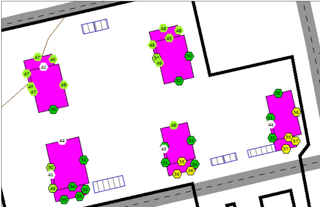
Kuva 13 Vaiheen 1. yöajan keskiäänitasot julkisivuilla.
