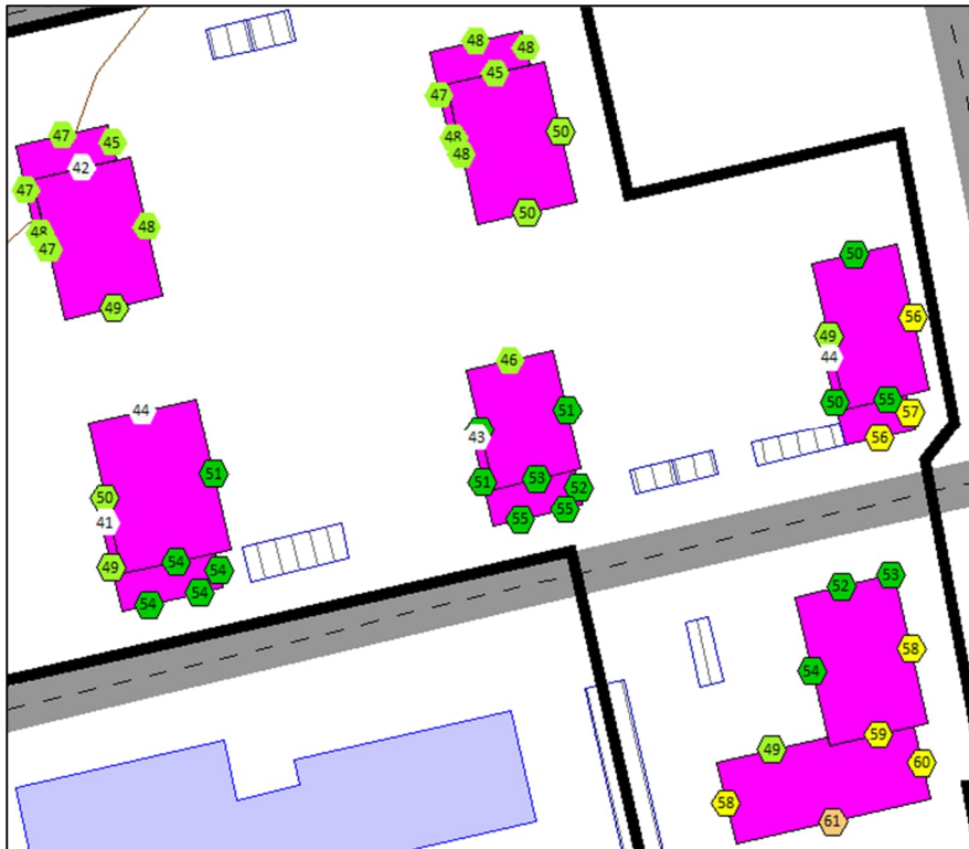
Kuva 17 Vaiheen 2. yöajan keskiäänitasot julkisivuilla.
