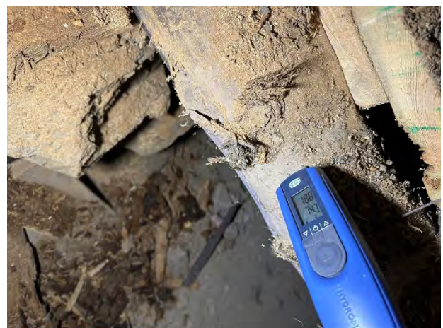
Kuva 71. Alapohjan kantavasta palkista mitattu kohonneita kosteuslukemia, kuvassa painoprosentit 18,8 (raja-arvo on 18,0).
